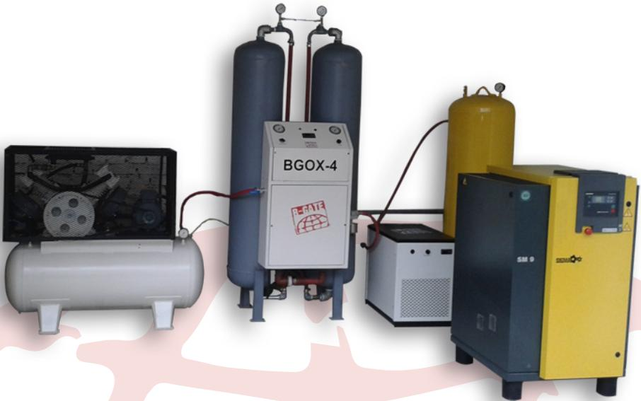
Sistema enriquecedor de aire, por método PSA (Pressure Swiching Adsorption), concentraciones de  $93\pm 1\%$  y  $99\pm 0.7\%$ , presiones de salida desde 60 a 100 PSI, caudales desde 2 m<sup>3</sup>/Hr a 50 m<sup>3</sup>/Hr de producción. Consumo promedio eléctrico de 2,5Kw/m<sup>3</sup> oxígeno, sistema de medición online de oxígeno por celda electroquímica o paramagnético, medición de CO (monóxido), almacenamiento de datos mediante DataLogger digital.
