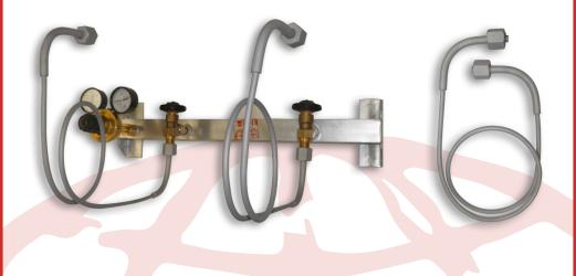
Colectores de alta presión, presión máxima de trabajo 250 Bar, llave robinete independiente a cada cilindro/termo liquido, desde 1 a 10 cilindros por sección, regulador de presión en Latón forjado, salida max. 12 Bar, caudal 50 m3/Hr, para montaje sobre pared o con pie. Acople de interconexión flexible en cobre o teflón mallado en acero inoxidable, presión max. 200 Bar, largos de 500 mm a 1500 mm.
